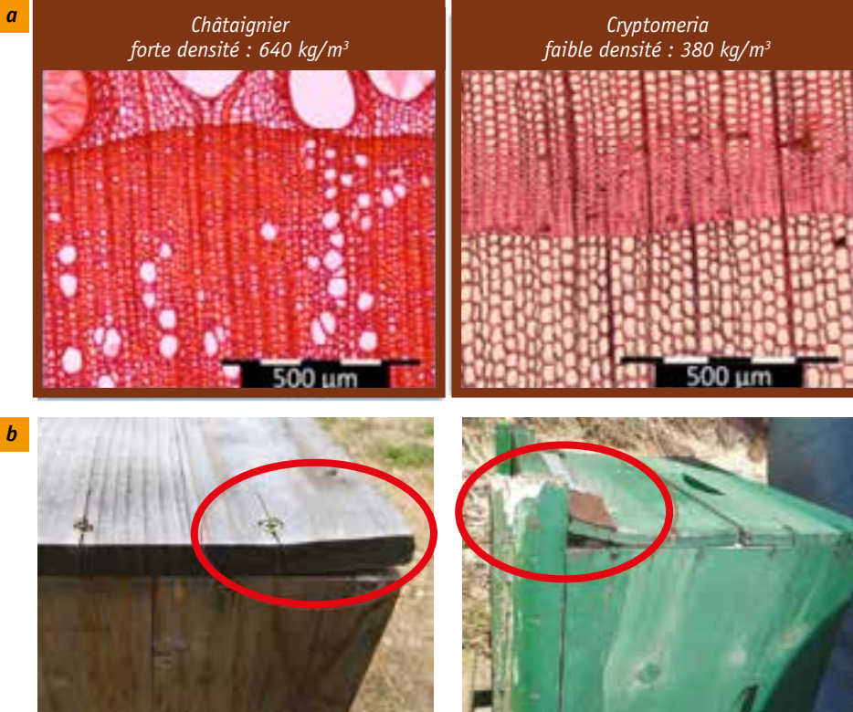
Fig.4. (a) Vue anatomique du bois de châtaignier plus dense que le cryptomeria plus léger donc meilleur isolant); (b) Ruches abimées après quelques années d'utilisation à cause d'une fabrication non adaptée (due aux choix d'essences, types d'assemblage, qualité du bois) aux conditions de mise en service d'une ruche (crédits photo: (a) M.-C. Trouy; (b) A. Dupleix / P. de la Rue du Can).
