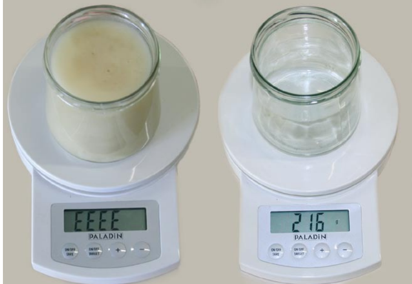
Fig.4 La portée de la balance doit supporter la masse totale à peser, soit le contenant (216 g) + le contenu (500 g).
