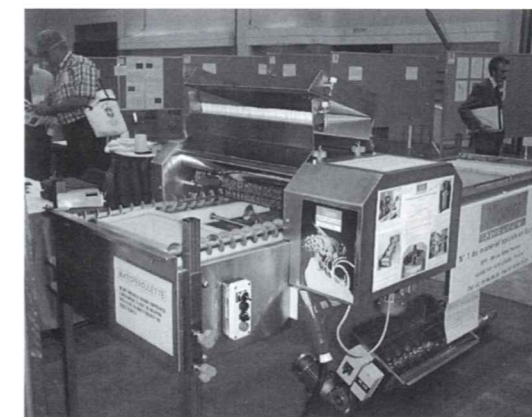
Nouveauté intéressante chez Thomas : la machine à désoperculer les cadres Hoffman améliorée. Les cadres avancent automatiquement à l'horizontale sur un tapis et sont rangés après désoperculation, toujours automatiquement, dans des hausses en INOX. (Photo iT Magazin)
