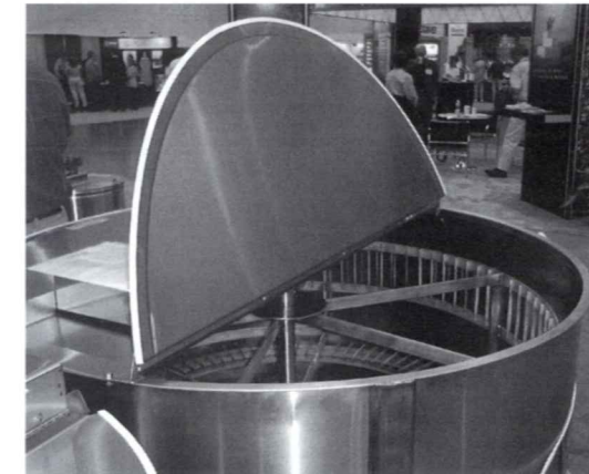
Extracteur radiaire Dadant avec régulation électronique. On remarque la stabilité du panier. Capacité : 60 cadres. (Photo iT Magazin)
