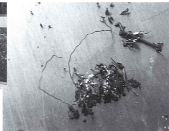
Particules métalliques retenues par l'aimant placé au-dessus du tapis roulant (Photo R. Michiels)
